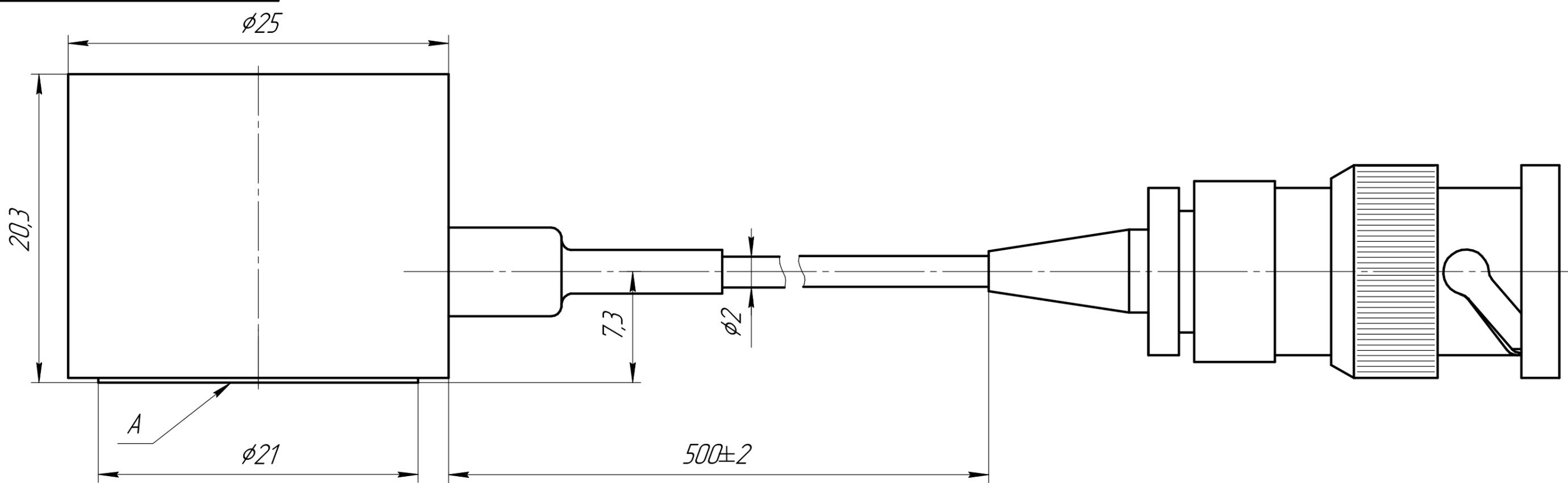
1. Преобразователь акустической эмиссии GT350 устанавливать на объект испытаний поверхностью А с усилием поджатия 2-10 Н, используя для обеспечения акустического контакта любую среду (силиконовая жидкость, вода, вазелин и т. п.). Поверхность объекта испытаний, на которую устанавливается
