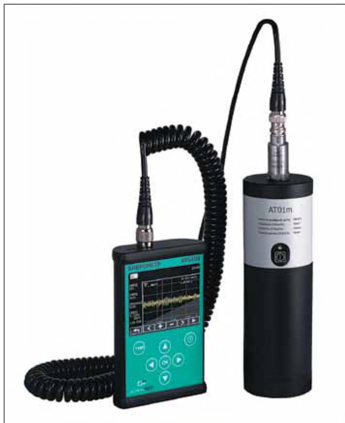
Рис. 2. Подключение к калибратору
